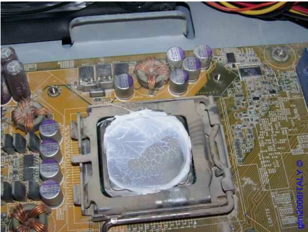
Ecco la pasta termica dopo la "pressione" del dissipatore
