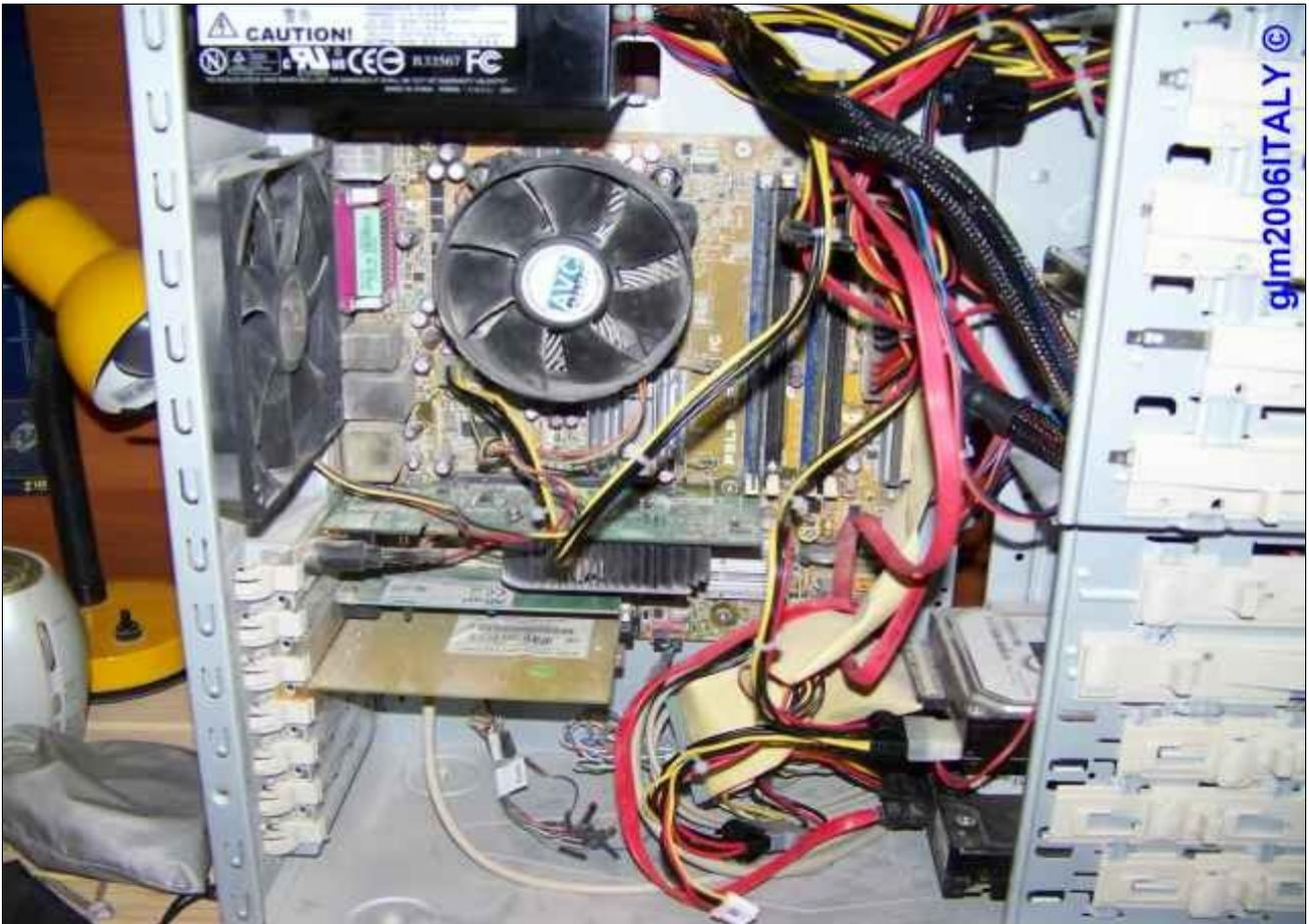
*Ecco l'interno del pc.... da notare i cavi raggruppati in maniera di non interferire con i componenti hardware*
